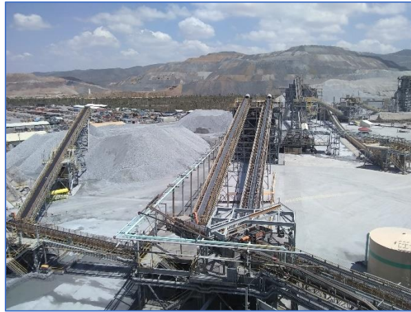
Figura 7 Fotografía de bandas transportadoras de mineral entre los circuitos de trituración y molienda
