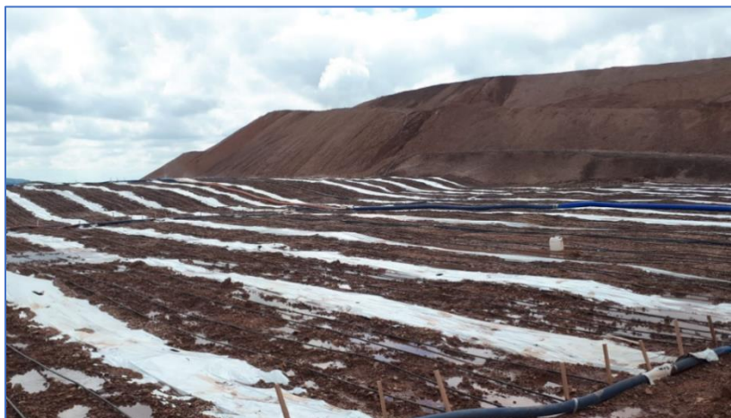
Figura 10 Fotografía que muestra el desarrollo del proceso de lixiviación
