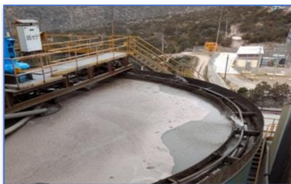
Figura 9 Fotografía de un tanque de recirculación del agua de proceso de flotación selectiva
