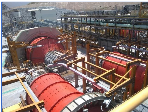
Figura 6 Fotografía panorámica de un circuito de molienda en Minera Peñasquito
