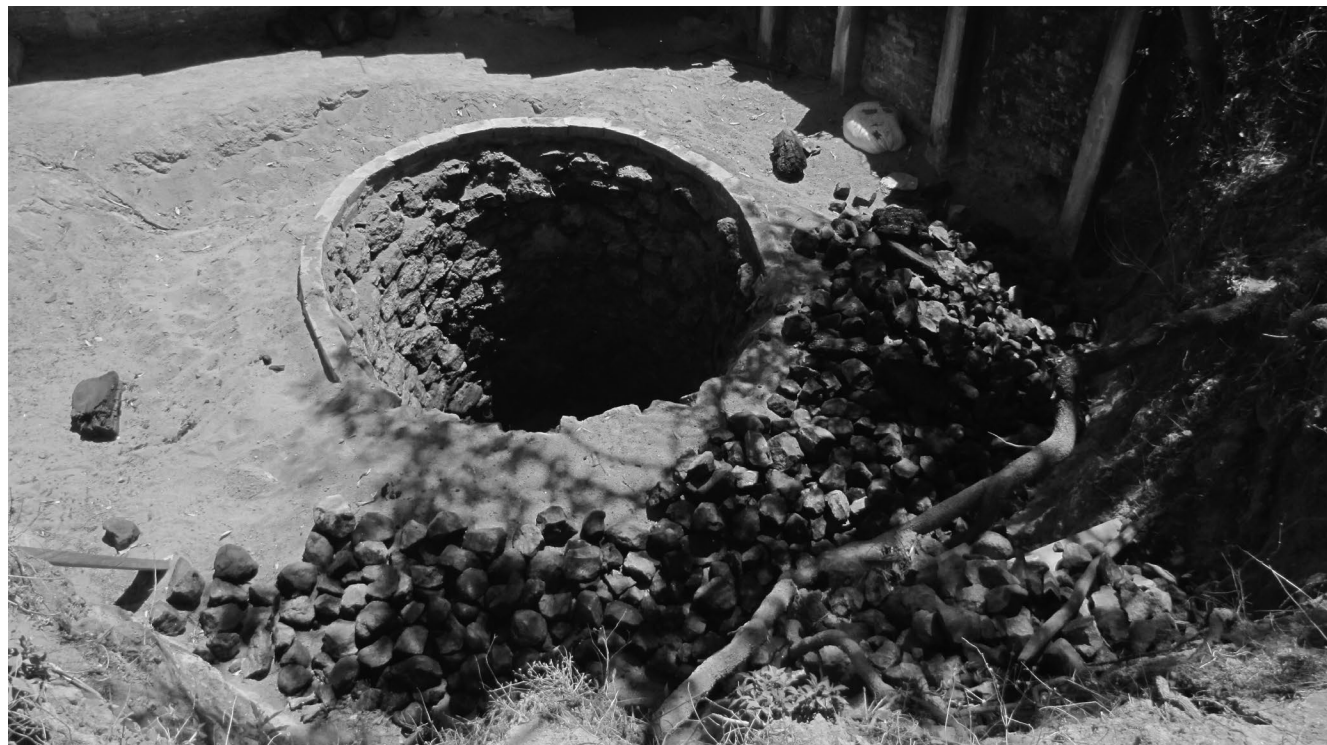
Horno de piedra subterráneo para la producción de mezcal tradicional.
